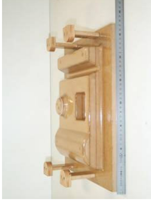
Outillage rapide de coulée pour béton réfractaire (Médium)
